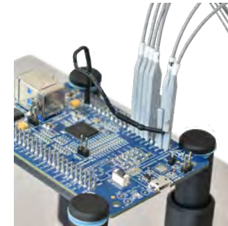
Per le intestazioni con segnali situati insieme e con motivi insufficienti. Un cavo di terra può essere utilizzato per il collegamento a un pin di terra remoto sul dispositivo in prova.
