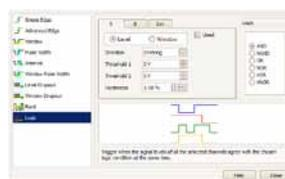
Oltre alla gamma di trigger standard presenti in tutti gli oscilloscopi, il PicoScope serie 5000 offre un set di trigger ai vertici della categoria per agevolare l'acquisizione dei dati desiderati, tra cui larghezza di impulso, trigger con finestra e con dropout.
