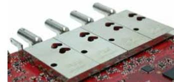
Un front end progettato con cura e l'uso di apposite schermature riducono il rumore, la diafonia e la distorsione armonica. Anni di esperienza nel settore degli oscilloscopi ci hanno permesso di migliorare la risposta agli
