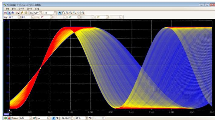
È possibile visualizzare dati vecchi e nuovi sovrapposti, con i dati nuovi in colori più brillanti o ombreggiati per semplificare l'individuazione di disturbi e dropout e la stima della frequenza relativa. Si può scegliere tra persistenza analogica e colore digitale, oppure creare una modalità di visualizzazione personalizzata.
