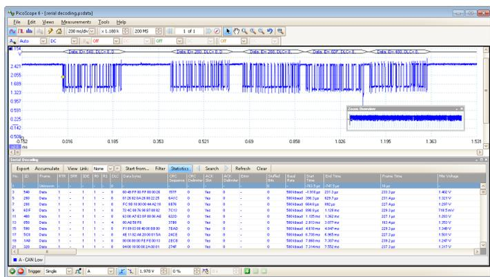
Il PicoScope serie 3000, con la sua memoria profonda, è ideale per la decodifica digitale poiché consente di acquisire migliaia di frame in sequenze di dati ininterrotte.
