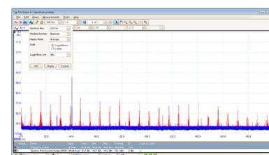
Con un semplice clic su un tasto, è possibile visualizzare il grafico dello spettro per i canali selezionati. L'analizzatore di spettro consente di visualizzare segnali fino a 200 MHz nel dominio della frequenza. Un'ampia gamma di impostazioni offre la possibilità di controllare il numero di bande di spettro, i tipi di finestre e le modalità di visualizzazione: istantanea, media, oppure tenuta di picco.
