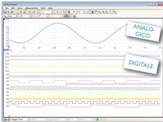
Il trigger digitale riduce il ritardo di riarmo, caratteristica che, combinata con la memoria segmentata, permette di innescare e catturare eventi in rapida sequenza. Per gli ingressi analogici, la funzione di verifica dei limiti con maschere analizza il buffer per evidenziare le forme d'onda difettose e visualizzarle nella finestra di navigazione.
