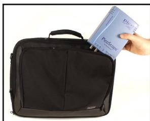
Gli oscilloscopi Pico alimentati tramite USB inoltre sono piccoli, leggeri e portatili: stanno facilmente in una custodia per computer portatili e sono pertanto ideali per il tecnico che debba spostarsi frequentemente. Poiché non richiedono un'alimentazione esterna, sono ideali per l'impiego sul campo in molte applicazioni come progettazione, ricerca, verifica, formazione, manutenzione e riparazione.
