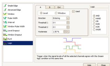
Oltre alla gamma di trigger standard presenti in tutti gli oscilloscopi, il PicoScope serie 3000 offre un set di trigger ai vertici della categoria per agevolare l'acquisizione dei dati desiderati, tra cui larghezza di impulso, trigger con finestra e con dropout.
