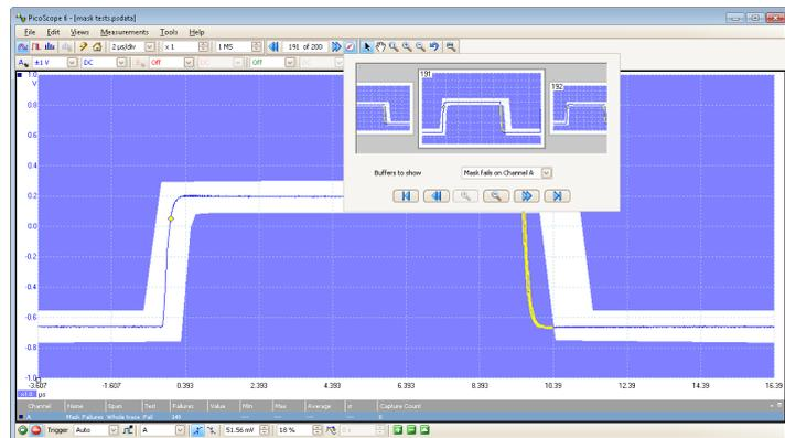
Gli editor numerico e grafico possono essere utilizzati separatamente o combinati tra loro consentendo all'utente di inserire precise specifiche delle maschere e modificare le maschere esistenti. Le maschere possono essere importate ed esportate come file.
