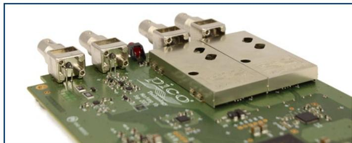
Un front end progettato con cura e l'uso di apposite schermature riducono il rumore, la diafonia e la distorsione armonica. Anni di esperienza nel settore degli oscilloscopi ci hanno permesso di migliorare la risposta agli impulsi e la linearità della larghezza di banda.
