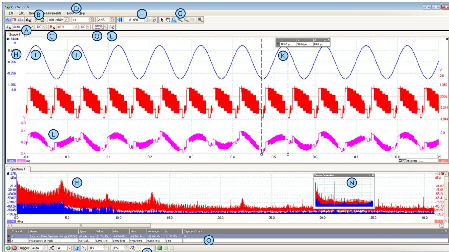
**A** I comandi comunemente utilizzati, come selezione della gamma tensione, base dei tempi, profondità di memoria e selezione dei canali, si trovano sulle barre degli strumenti ad accesso rapido, lasciando libera l'area principale dello schermo per le forme d'onda.
