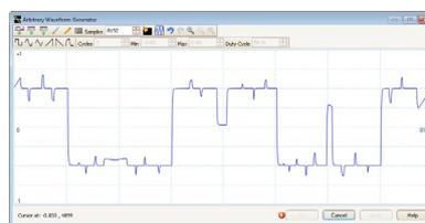
Tutte le unità sono dotate di generatore di funzioni integrato (forme d'onda sinusoidali, quadre, triangolari, di livello CC). I comandi di base permettono di regolare livelli, offset e frequenza, mentre quelli più avanzati consentono di lavorare su diverse gamme di frequenza. Queste funzioni, insieme all'opzione di mantenimento del picco di spettro, rendono questo strumento ideale per testare amplificatori e risposte dei filtri.
