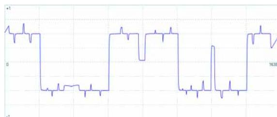
Lo strumento integra anche un generatore di forma d'onda arbitraria interamente programmabile con buffer da 8.000 campioni.
