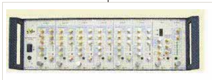
Bit error rate tester Luceo Technologies con bit rate fino a 100 Gbit
