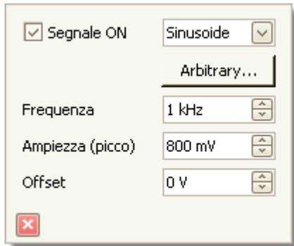
Questo dialogo controlla un canale della sorgente di segnale di dimostrazione, una funzione di PicoScope che crea una varietà di segnali di prova per simulare un dispositivo.
