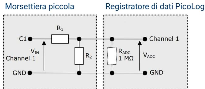
Questo circuito mostra il partitore di tensione per il canale analogico 1. Le connessioni sono simili per altri canali. È necessario tagliare una traccia sulla morsettiere e montare due resistori con montaggio superficiale 0805 o conduttori assiali per ciascun canale che si desidera utilizzare in questo modo.
